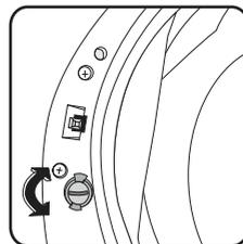
Pour **désactiver** ce dispositif et permettre la fermeture du hublot, tournez le bouton dans le sens inverse des aiguilles d'une montre jusqu'à ce que la rainure soit verticale.
