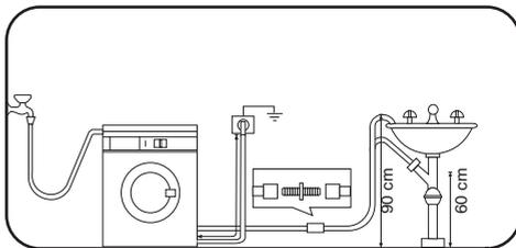
**Pour un fonctionnement correct de l'appareil, le tuyau de vidange doit rester accroché à son support situé sur la partie supérieure, à l'arrière de l'appareil.**
