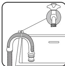
A cet effet, vous pouvez fixer le tuyau au robinet à l'aide d'une ficelle ou le fixer au mur.
