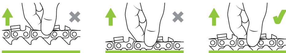
10. Si la chaîne est trop lâche ou trop serrée, desserrez les vis avant d'ajuster le tenseur de la chaîne. Si vous ne desserrez pas les vis, le tenseur s'endommagera et ceci annulera la garantie.
