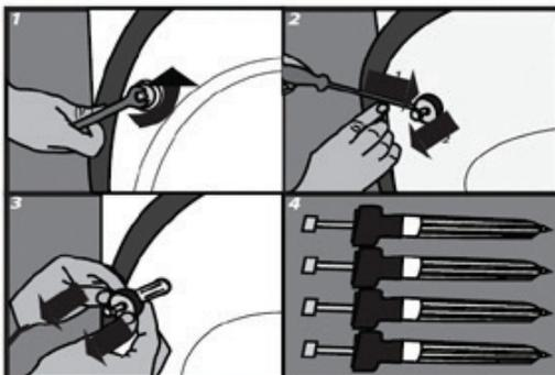
3. Mettez les vis de bridage de côté (figure 4) en cas de réutilisation ultérieure, puis bouchez les orifices avec les caches en plastique fournis.
