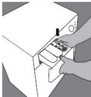
2. Pour dégager le siphon du compartiment pour l'assouplissant, appuyez sur la « patte » située à droite du compartiment comme indiqué sur la figure ci-dessous.
