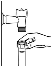
2. Raccordez l'autre extrémité du tuyau au robinet d'eau. Veillez ensuite à bien serrer l'écrou de serrage à la main (Figure ci-contre).
