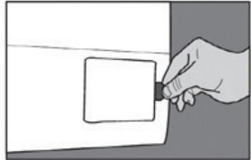
3. Avant d'ouvrir le couvercle du filtre, placez un récipient sous la trappe pour empêcher l'écoulement par terre de l'eau restante dans la machine (Fig. ci-contre).
