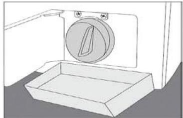
4. Desserrez le couvercle du filtre en le faisant tourner dans le sens inverse des aiguilles d'une montre et laissez l'eau couler (Fig. ci-contre).
