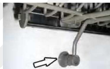
Retirez le capuchon de protection puis, placez les roulettes supérieures ou inférieures dans les rails.
