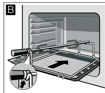
3. Enfournier la lèche-frite au niveau 1 jusqu'en butée. La paroi arrière du four possède un orifice. Le tournebroche doit être introduit dans cet orifice (fig. C).
