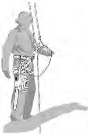
Image B1 – Exemple de fixation d'une tronçonneuse d'élagage sur le harnais de l'opérateur
