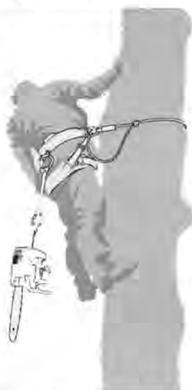
Image B2 – Exemple de fixation d'une tronçonneuse d'élagage au point d'attache central arrière d'un harnais
