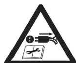
Retirer la fiche de réseau lorsque le câble est endommagé ou avant tous travaux d'entretien ou de réparation.
